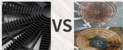
线盘匝间有安全距离，磁场分布均匀，散热好，是传统线盘的大升级。同行的线盘匝间安全距离不足、特别是底部发热大，易出现底部烧糊及匝间短路。
